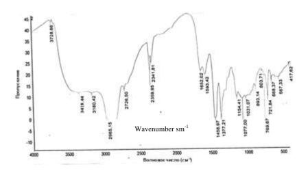
Fig. 3. IR spectrum chitosan.
